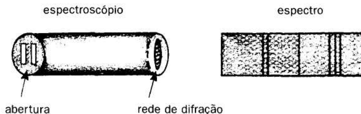
FIGURA 6.1: O espectroscópio e o espectro: a luz proveniente de uma fonte passa através da abertura, atingindo o retículo, localizado do lado oposto do espectroscópio. O espectro resultante exibe algumas linhas escuras.
